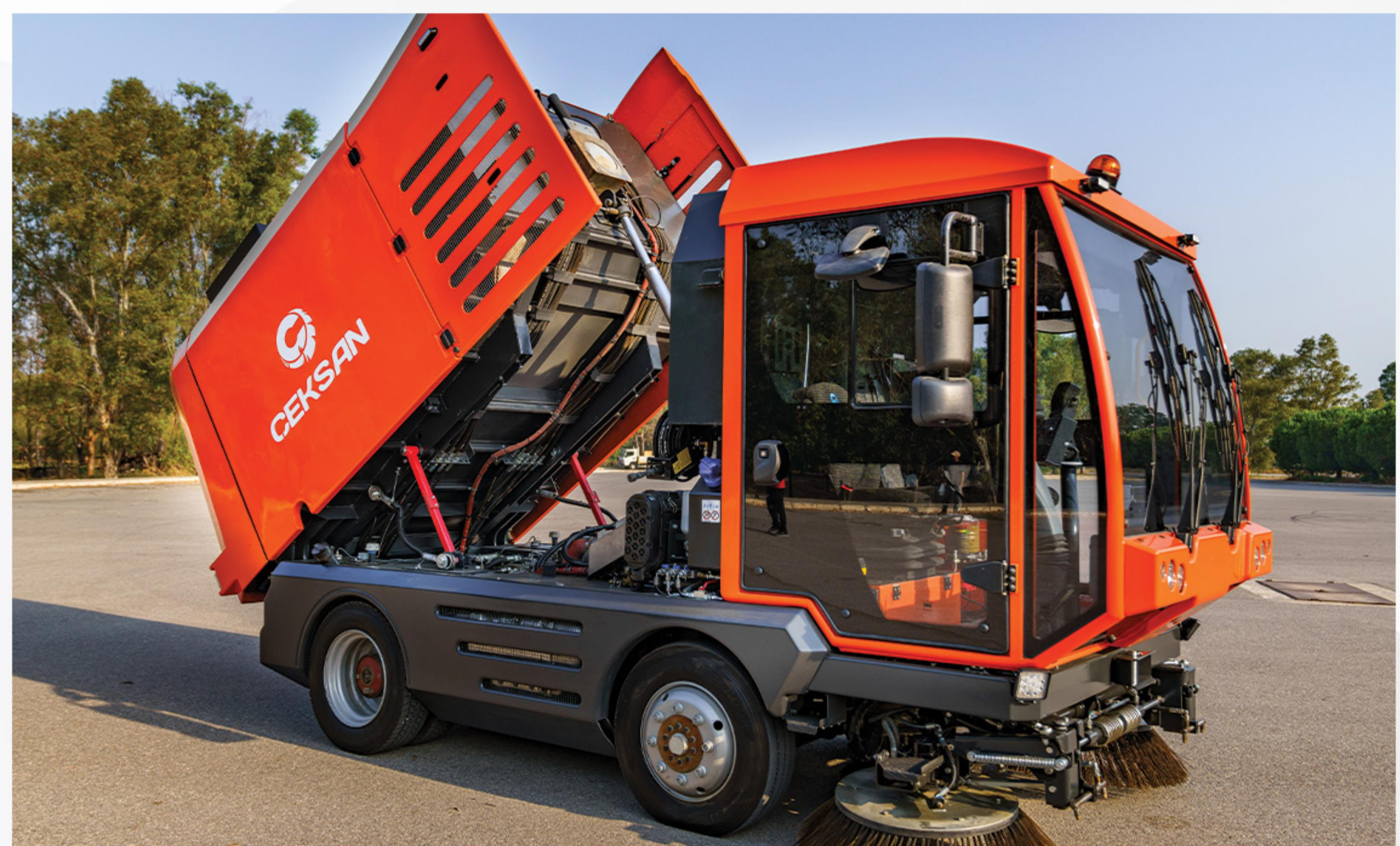
**Toz Önleme ve Sulama Sistemi:** Fırçaların üzerinde paslanmaz malzemeden su püskürtme nozulları bulunmaktadır. Fırçaların çalıştığı bölgede oluşan tozun dağılmasını önler. Vakum ağızının içinde ve çöp kazanı girişi vakum borusu üzerinde su püskürtme nozulları bulunmaktadır. Emiş esnasında toz partikülleri bu nozullar yardımıyla nemlendirilir ve toz sönümleme işlemi verimli bir şekilde gerçekleştirilir.
