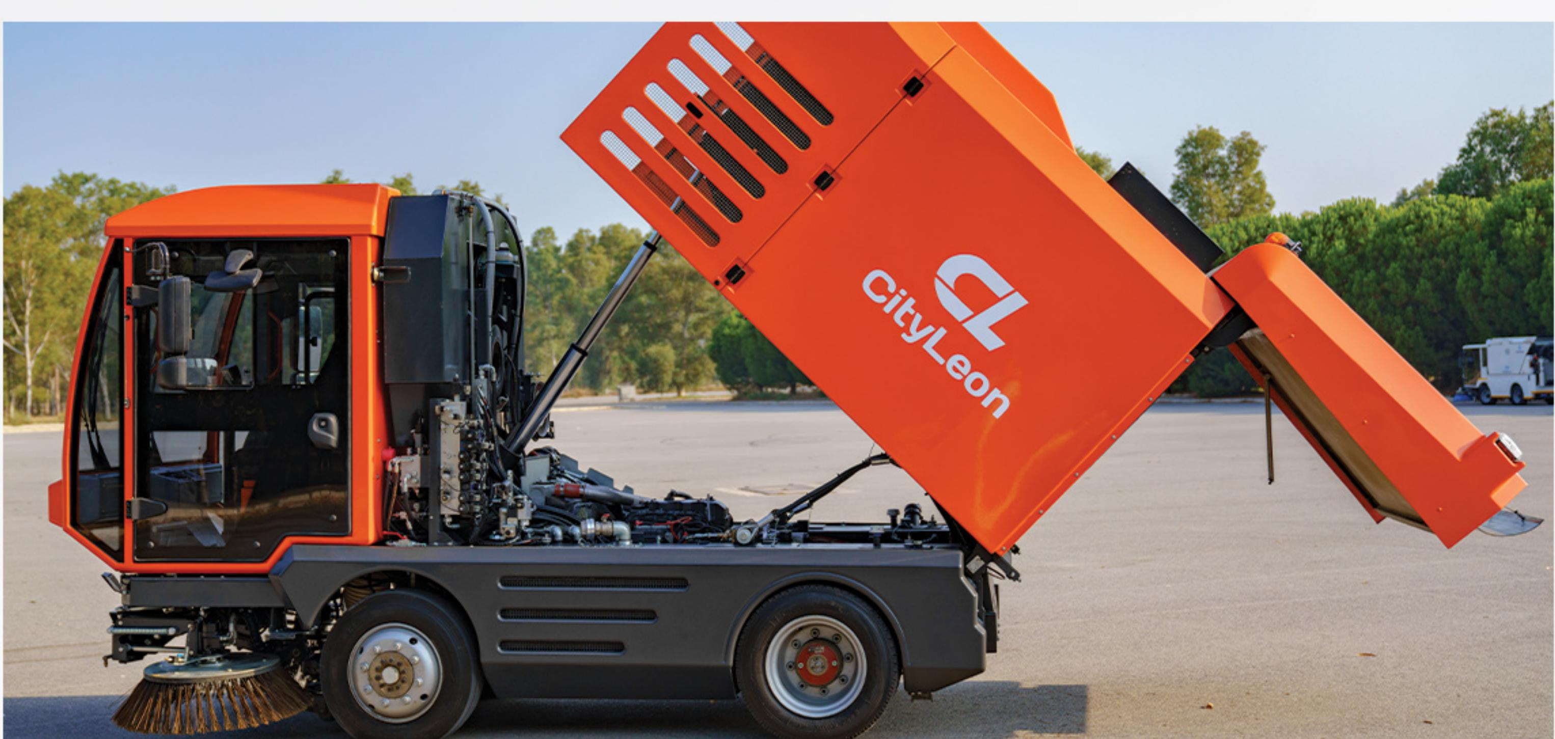
**Boşaltma:** CityLeon'da arka kapak hidrolik olarak açılmaktadır. Sızdırmazlığı sağlayan fitiller, bulunması gereken tüm yerlere donatılmıştır ve aynı zamanda dışarıdan havanın girmesini de öner. Arka boşaltma kapağı iki adet hidrolik silindir vasıtasyıyla kontrol edilir.
