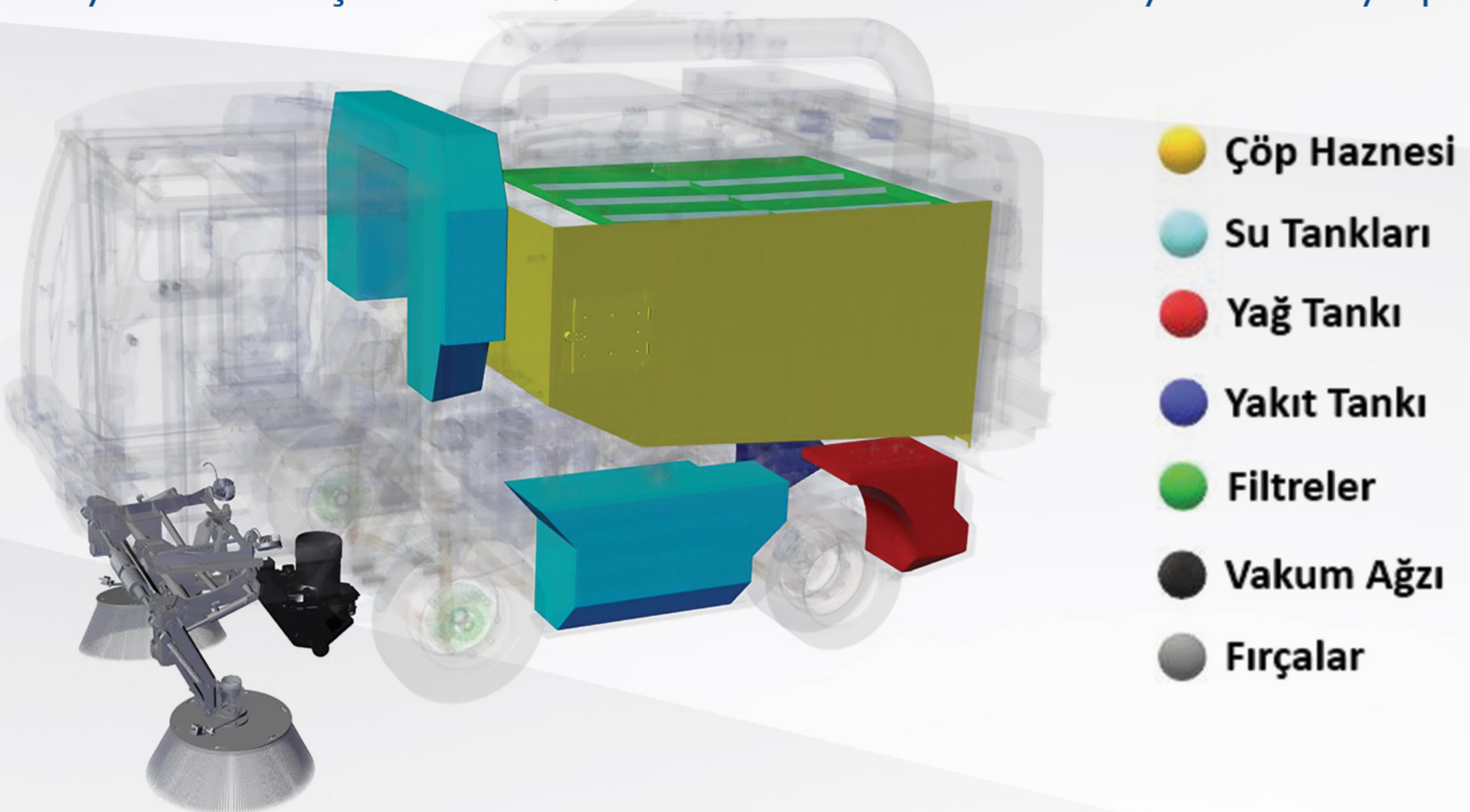
**Çöp Haznesi:** Paslanmaz çelik malzemeden imal edilmiş 6 m<sup>3</sup> çöp kazanı kendi sınıfında azami çöpü en hızlı bir şekilde toplamaya imkân tanır.
